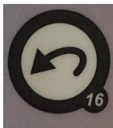
Il s'agit d'un bouton à commande **DOUBLE**, ce qui veut dire qu'il ne fonctionna pas tout seul : si nous appuyons sur ce bouton exclusivement, rien ne se produira ni dans notre console ni dans l'affichage devant. Pour que cela fonctionne, nous allons devoir appuyer **SIMULTANEMENT** sur le bouton « *de marche arrière* » et sur le bouton de l'action que nous souhaitons annuler.
